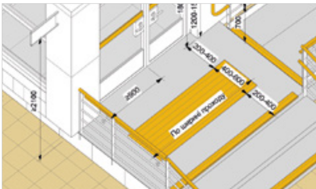
• Попереджувальня ТС перед входом в будівлю.
